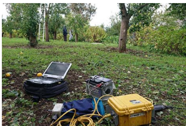
Figura 2-1– Esempio di esecuzione prova sismica a rifrazione
