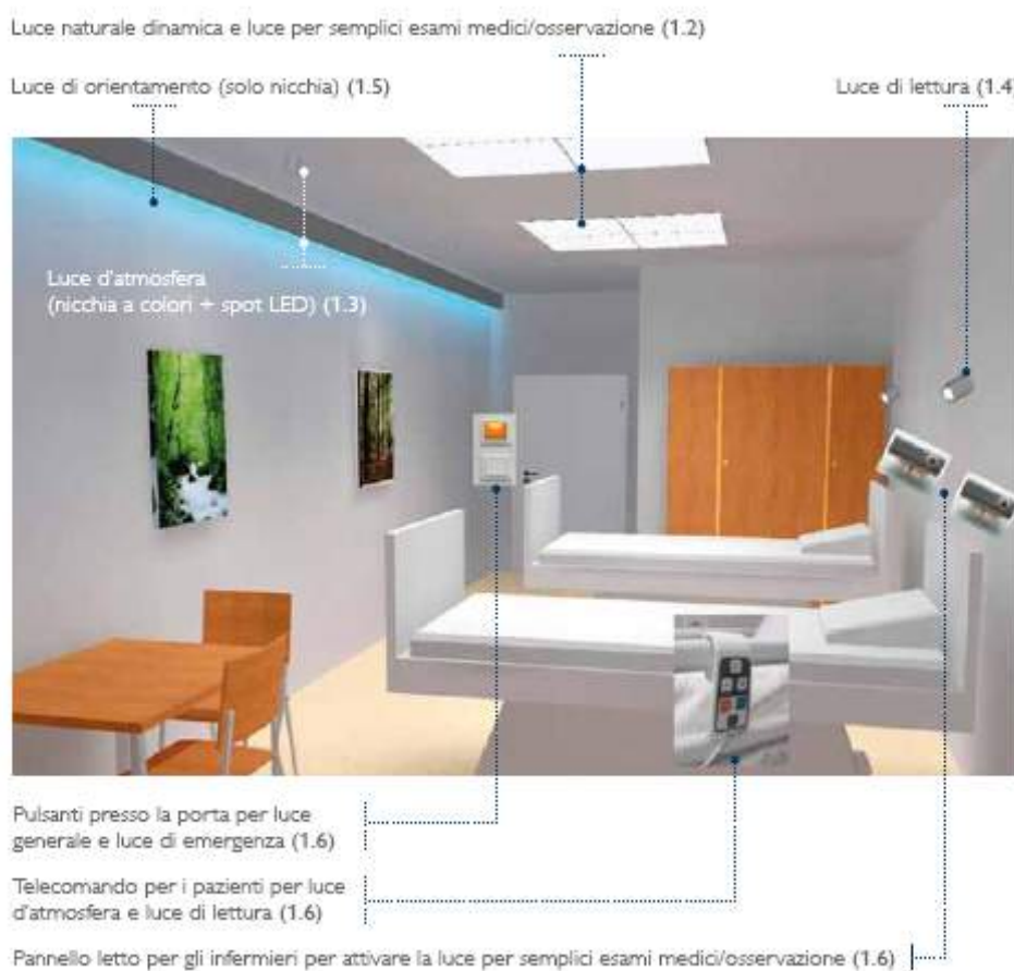
Figura 2: esempio di panoramica degli elementi del sistema di illuminazione in una stanza dei pazienti con due letti
