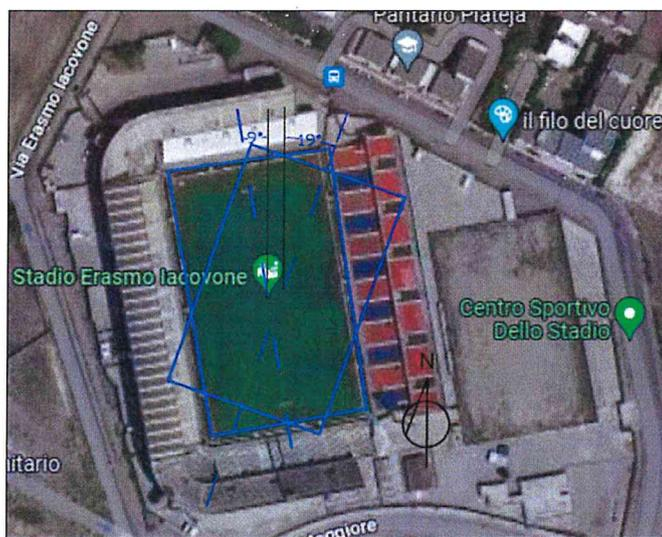
Fig. 1 : Confronto tra l'orientamento dello stadio esistente e quello in progetto
