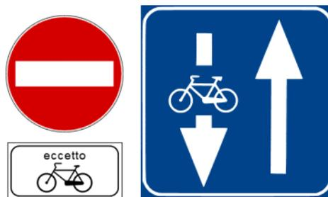
Figura 86 Segnaletica verticale per strade in cui non è possibile tracciare la linea discontinua di separazione dei due sensi di marcia
